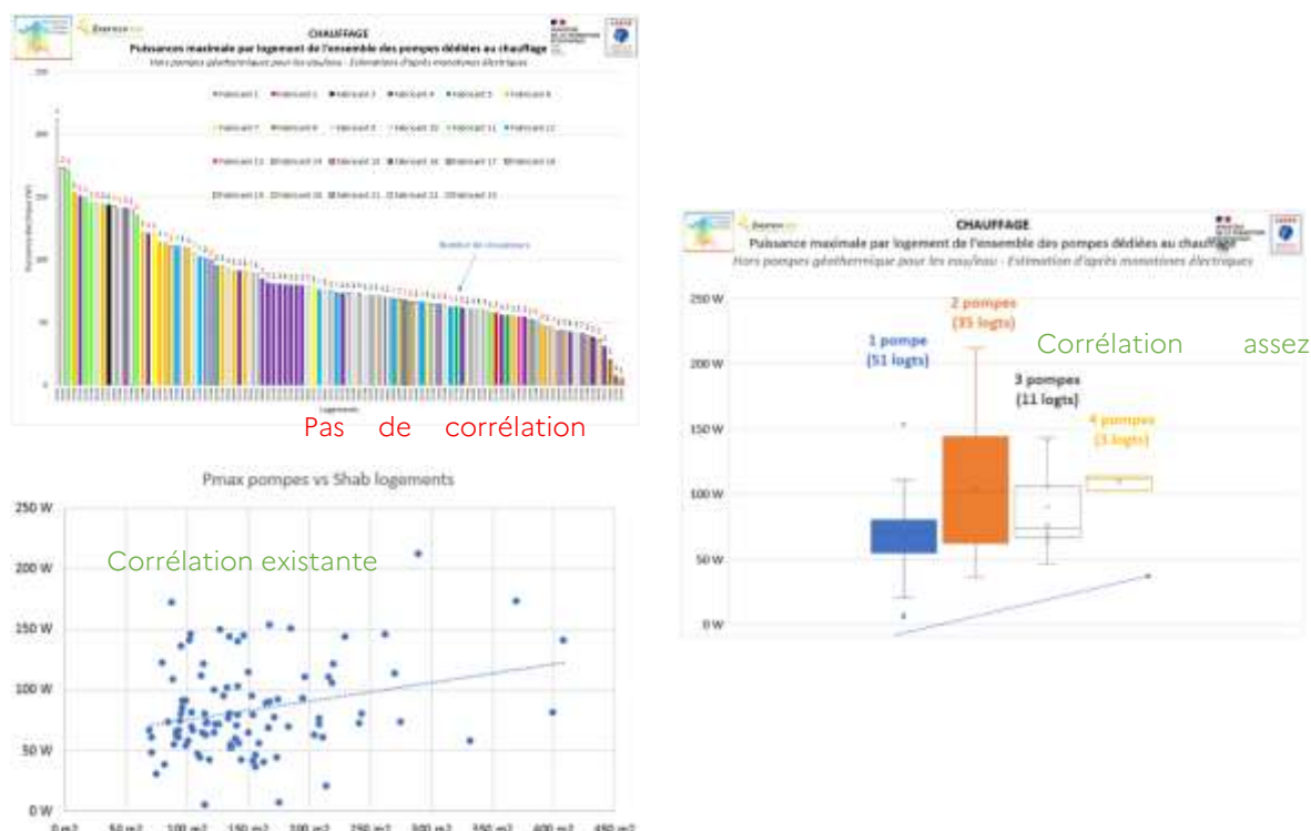
Figure 105 : Corrélations de la puissance maximale des circulateurs avec le fabricant, la surface des logements et le nombre de pompes
