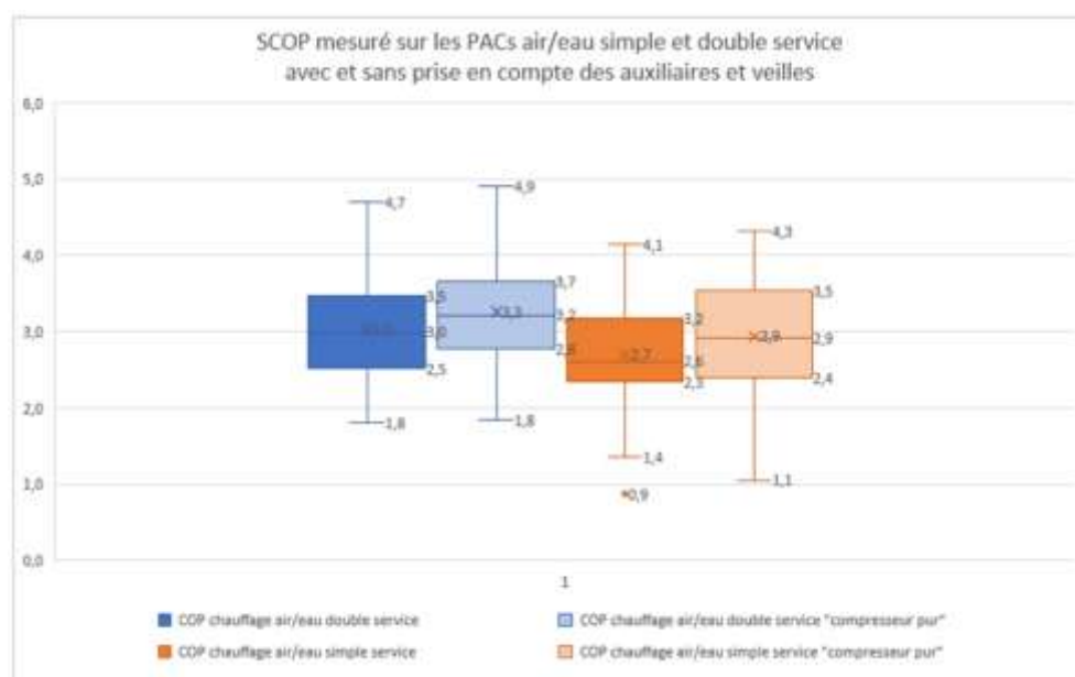
Figure 79 : Comparaison des SCOP chauffage mesurés entre les PAC simple et double service, avec et sans prise en compte des auxiliaires et veilles
